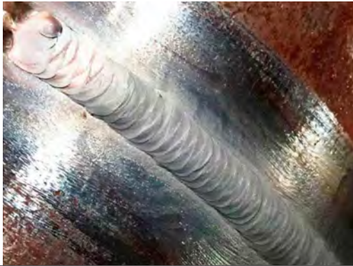
Figura 10. Unión a tope en tubería, pasada de acabado con el proceso 141.
