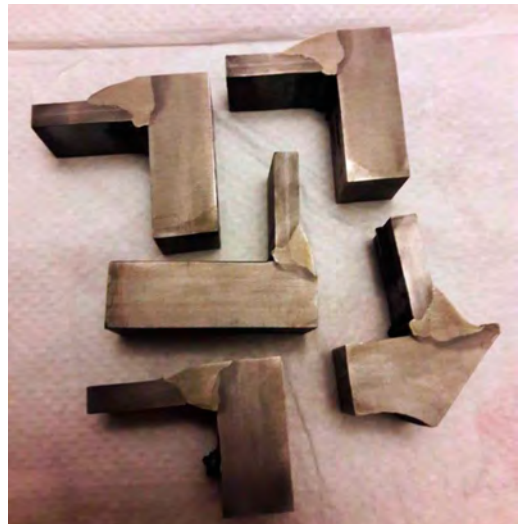
Figura 9. Muestra unos ensayos macroscópicos de unas uniones HV. La preparación típica que se emplea para tener una penetración total en las uniones en "T". Se aprecia la correcta penetración de las soldaduras, son testigos de producción que se realizan para evidenciar que las soldaduras se están realizando adecuadamente, cumpliendo a cabalidad los requisitos de fabricación.
