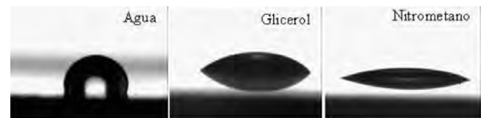
Figura 3. Imagen de las gotas de agua y glicerol y nitrometano
