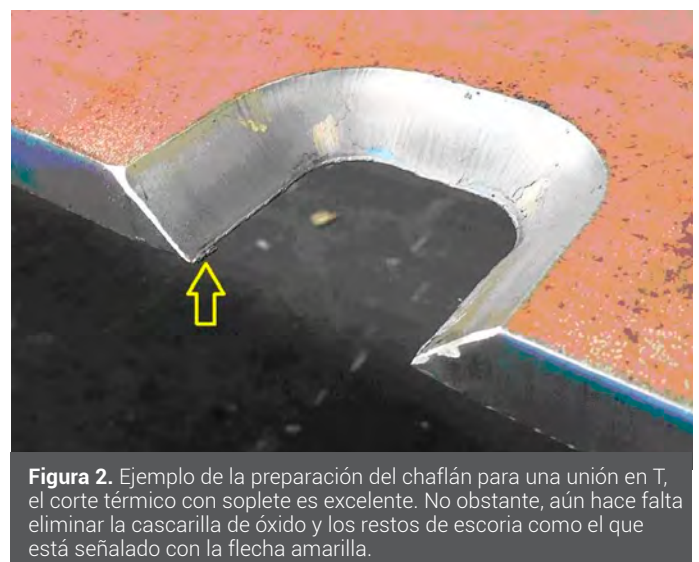
Figura 1. Ejemplo de la preparación de uniones indicadas en la tabla 4 de la Norma UNE EN ISO 9692-1.
